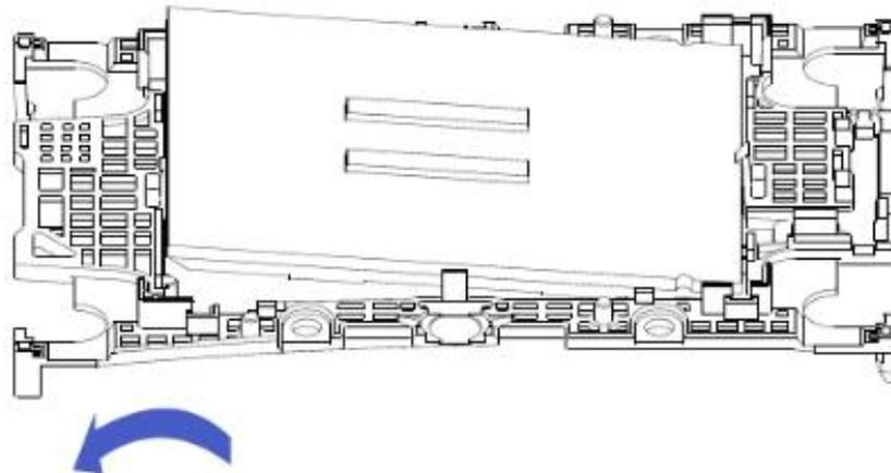
1-3. 松开夹持片，使夹持片另一端卡扣勾住 CPU 凹槽。
