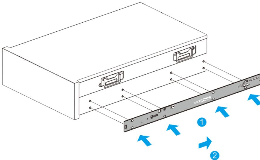
步骤 4.安装服务器到机架中.
