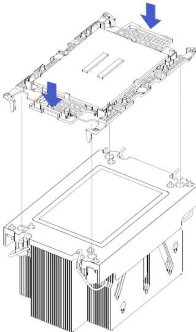
2-3. 仔细检查夹持片与散热器的安装情况，保证夹持片完全卡紧和平整。
