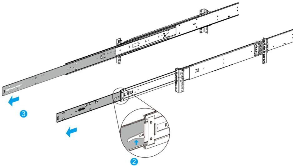
步骤 3.安装内轨到机箱上(左右内轨一样, 请重复安装)
