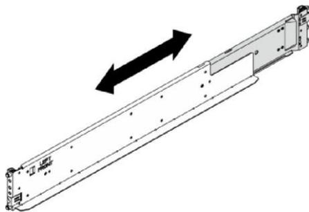
b. 从机架正面安装左导轨的后部安装支架。
